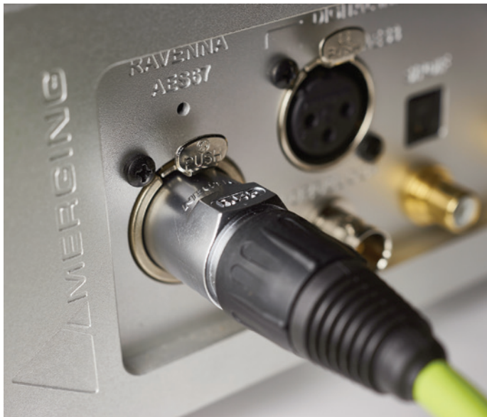
L'entrée RAVENNA et la prise Neutrik EtherCON avec le câble Cordial .
