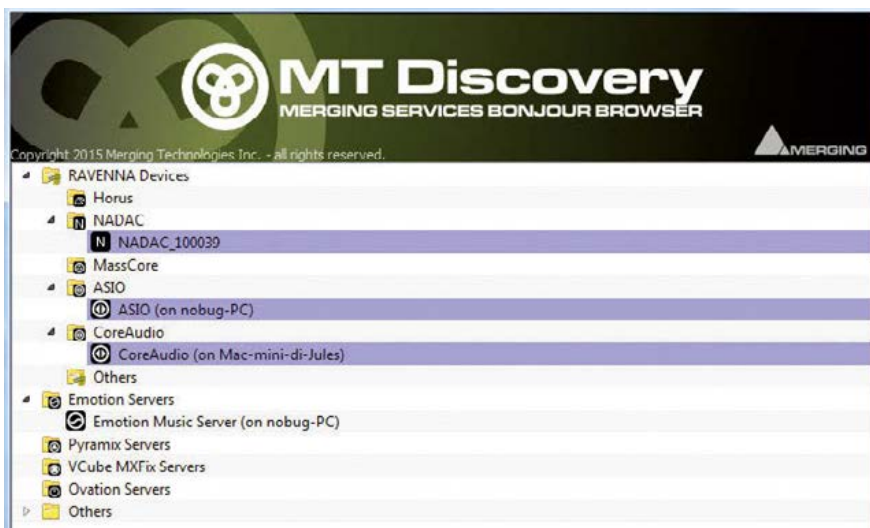
Foto 2 - Nella schermata principale di MT Discovery è possibile vedere i dispositivi Ravenna, in questo caso il NADAC in prova, quelli ASIO (PC) e quelli Core Audio (Mac), nonché l'istanza di Emotion attiva sul PC.
